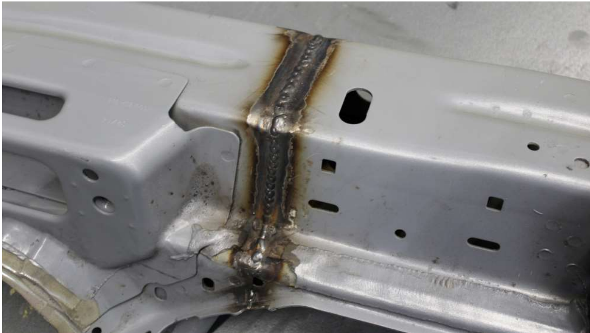
Die Schweißnaht beim Teilersatz eines Längsträgers wird nicht verschliffen und bleibt sichtbar. Quelle: TS.
